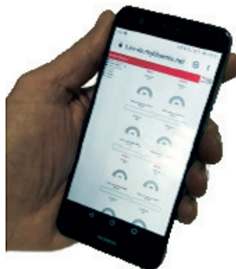
Figura 7: Possibilidade de verificar os dados de cada válvula e cilindro remotamente.
